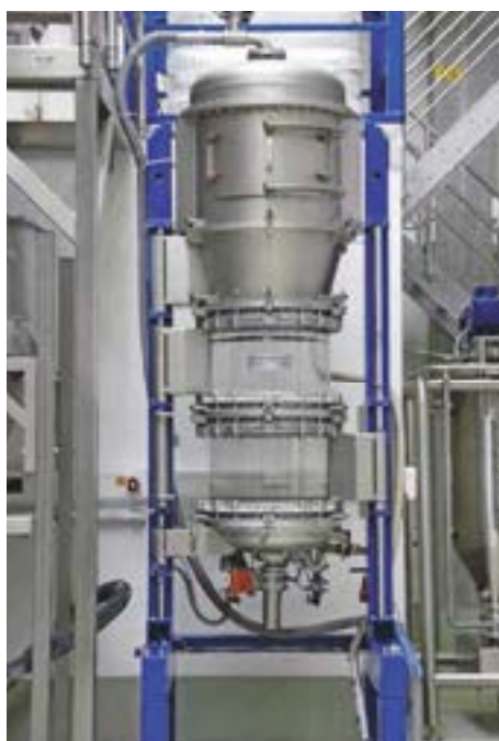
Der pneumatische Mischer (Homogenisier-Silo mit Fließbettboden) von Zeppelin Systems stellt ohne Frikationen oder große Reibung eine homogene Mischung her
